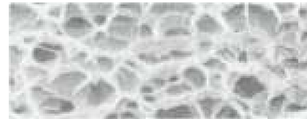
ECOミラーシート断面SEM写真 (走査型電子顕微鏡写真)
